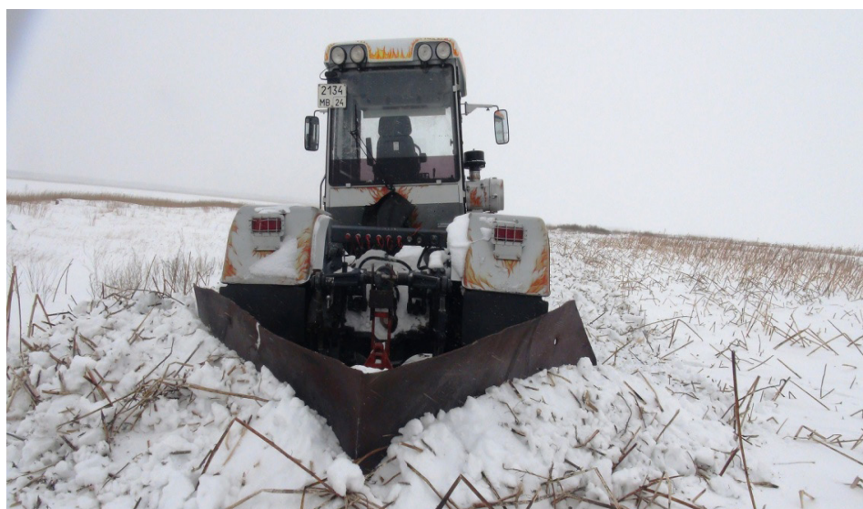
Рис. 3. Применение конусообразной навески для полосной расчистки биотехнических полей Fig. 3. Application of a cone-shaped headstock for strip clearing of biotechnical fields
