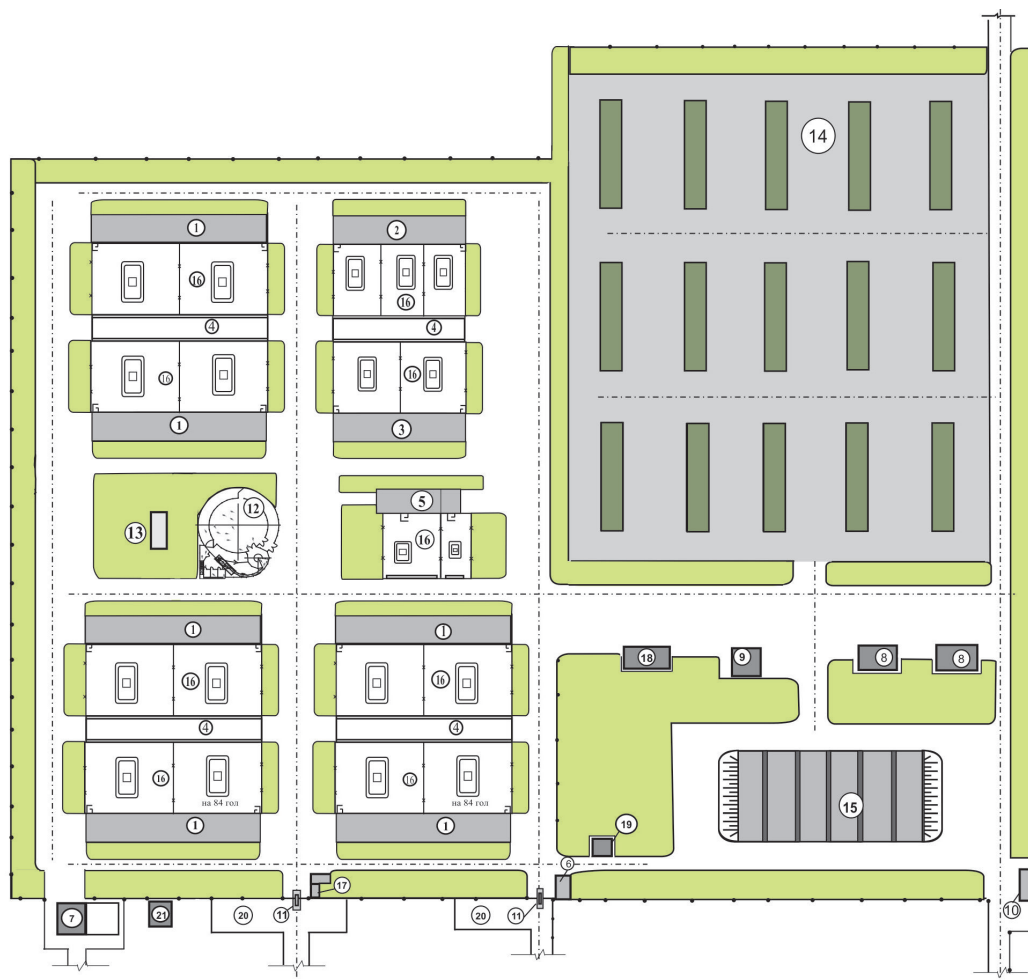
Схема генерального плана модульной фермы по производству говядины с трехуровневым отелом коров: 1 – коровник; 2 – здание для телочек с 8 до 16 месяцев; 3 – здание для телочек с 16 до 24 месяцев; 4 – кормовой навес; 5 – здание для быков-производителей; 6 – санпропускник; 7 – убойная площадка; 8 – зернохранилище; 9 – комбикормовый цех; 10 – весовая; 11 – дезбарьер; 12 – универсальная карда; 13 – раскол; 14 – площадка для хранения сена и подстилки; 15 – сенажная траншея; 16 – выгульные дворы; 17 – эстакада; 18 – стоянка для кормораздаточной техники; 19 – теплая стоянка для техники; 20 – автостоянка; 21 – бригадный дом
