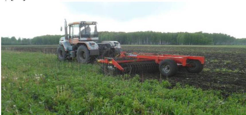
Рис. 5. Обработка почвы дискатором БДМ 4х2 П (с катками)
