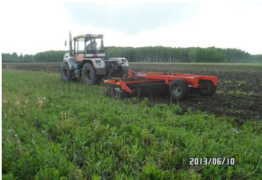
Рис. 4. - Обработка почвы дискатором БДМ 4*2 П (с катками). Заказник «Кирзинский»
