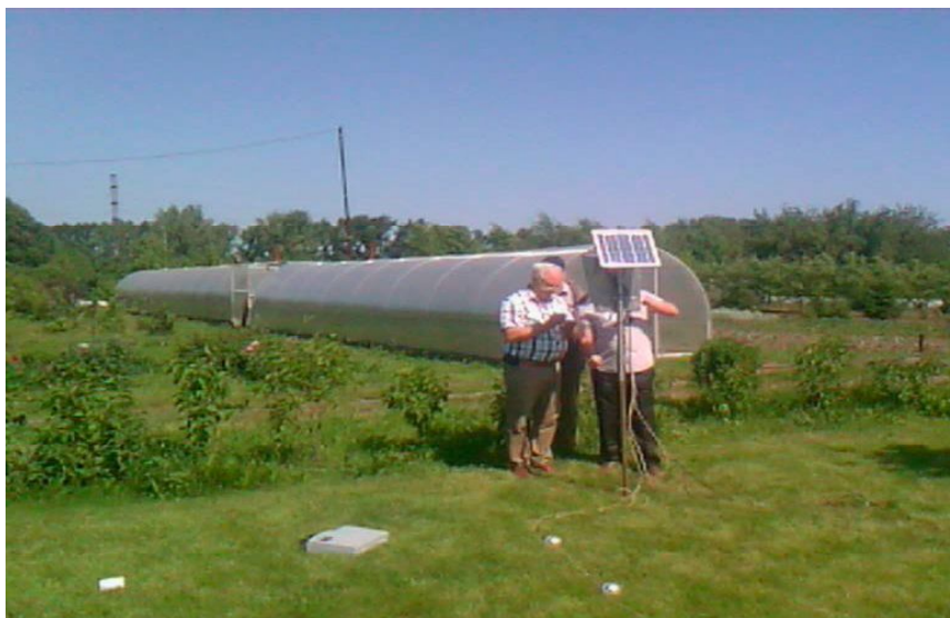
Рис. 6. Автономная станция измерения влажности и температуры почвы фирмы UGT, установленная на опытном поле Новосибирского ГАУ
